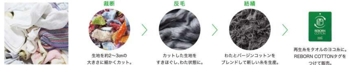
外製で行っていた反毛工程を自社工場で対応。
